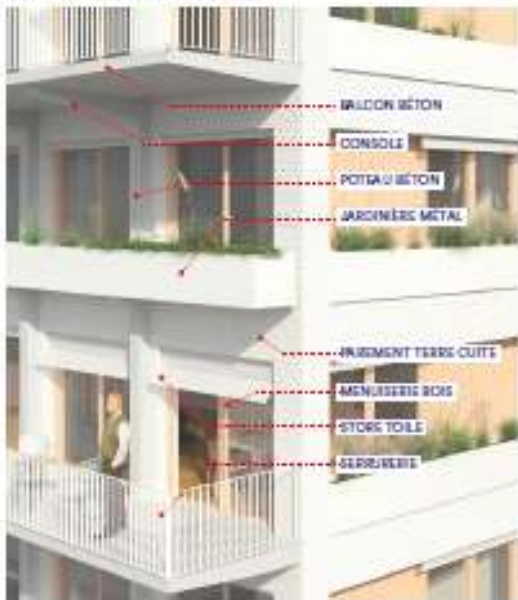
Détail de façade du lot 04
