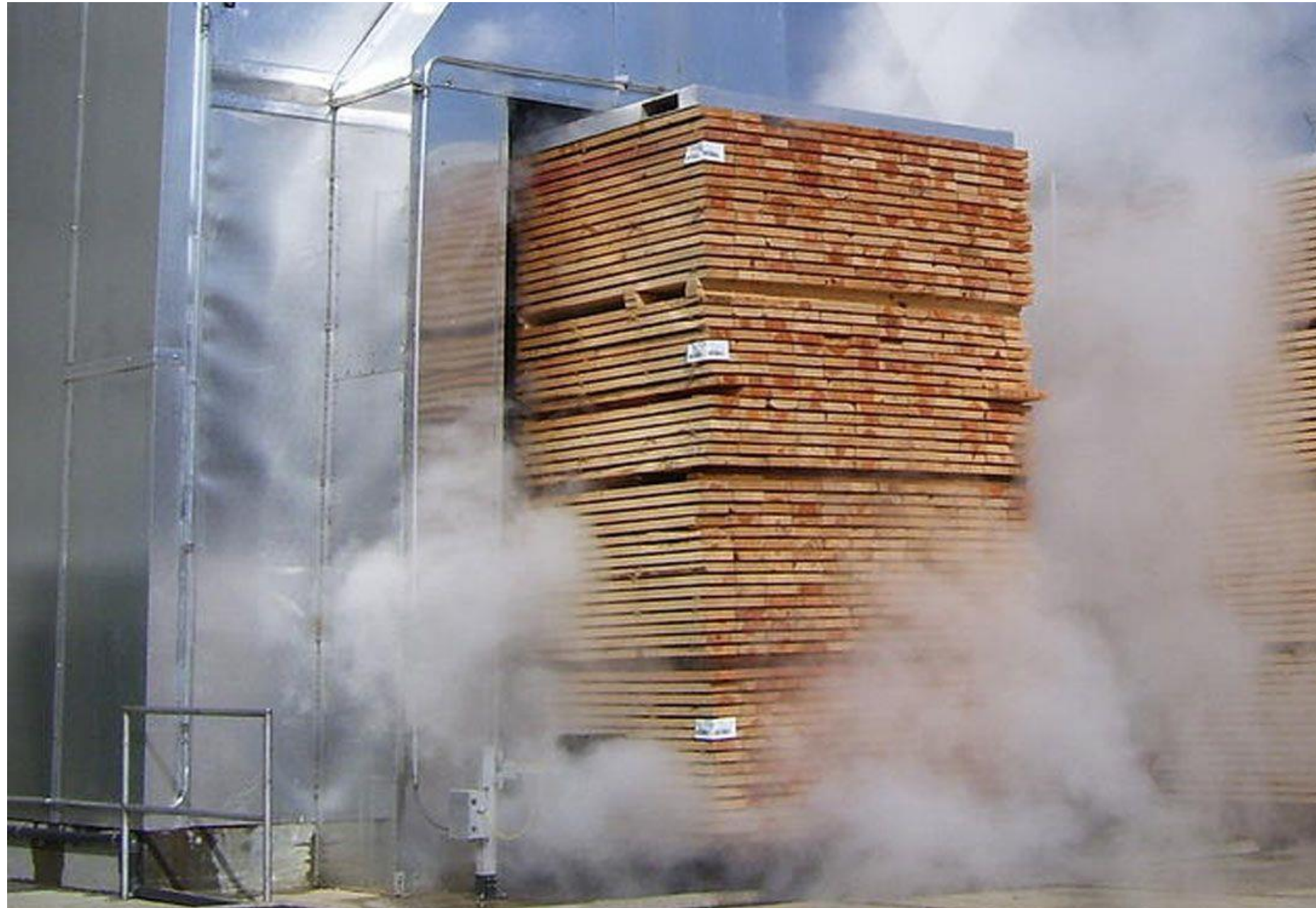
méthode conventionnelle = séchage HT avec vapeur (coils)
